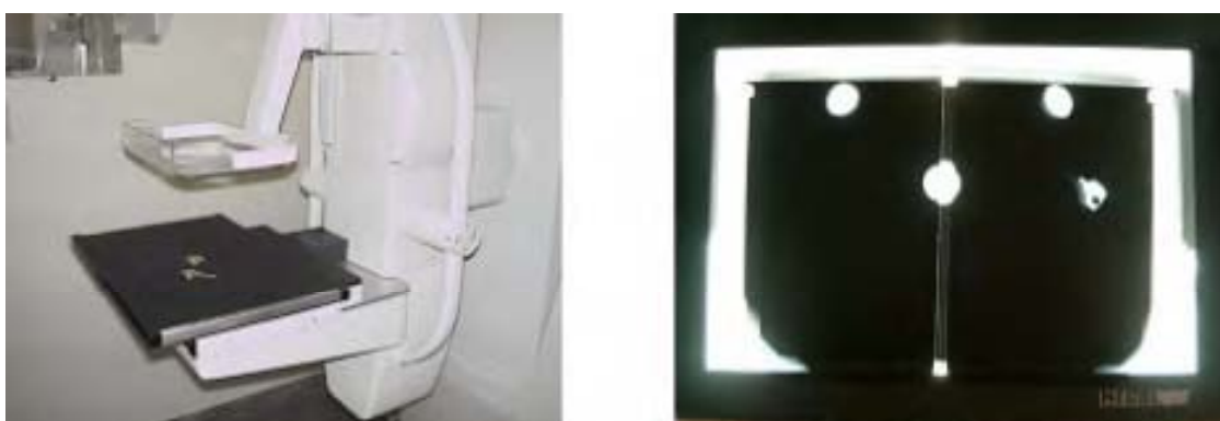
Figura 9. Arranjo e resultado do teste de alinhamento entre o campo de raios-X e o filme radiográfico.
