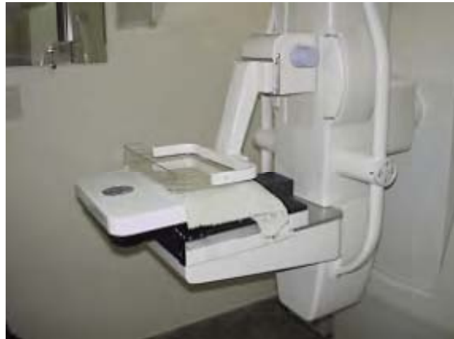
Figura 11. Arranjo do teste da força de compressão.
