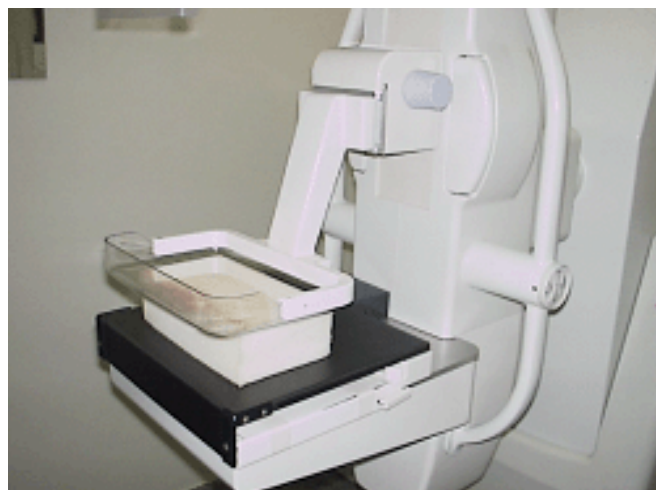
Figura 12. Arranjo do teste de alinhamento da bandeja de compressão.
